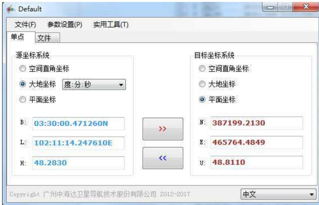
图 2-8 坐标转换工具单点转换界面
