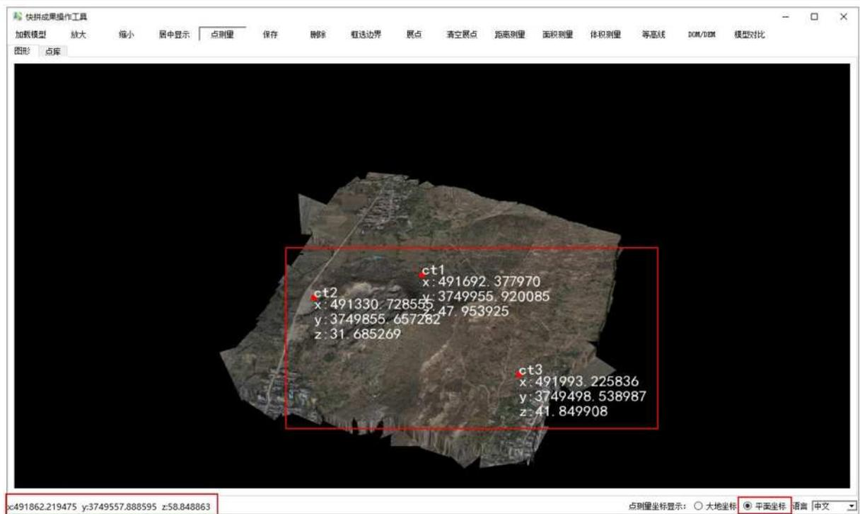
图 2-40 切换坐标显示类型
