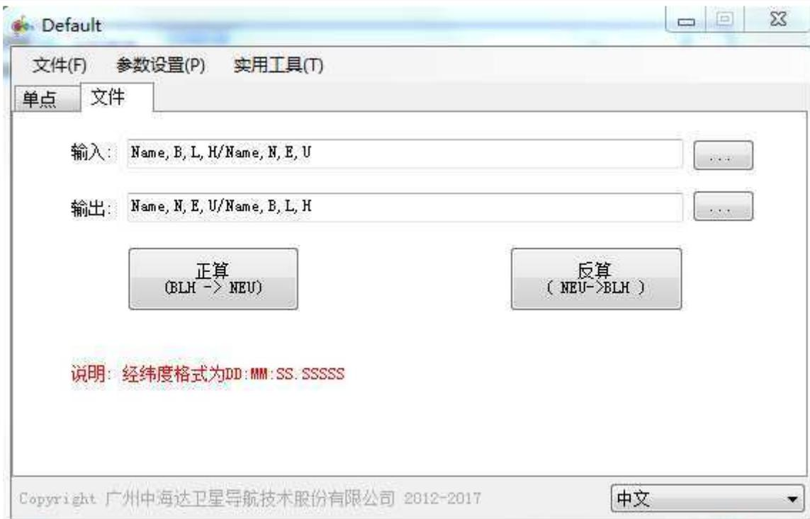
图 2-9 坐标转换工具点文件转换界面
