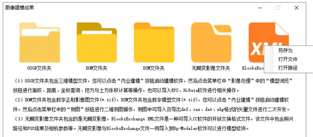
图 2-18 BlocksExchange XML 文件右键操作
