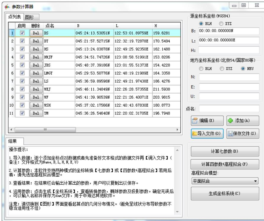
图 2-7 坐标转换工具参数计算器界面
