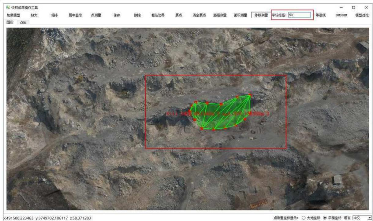
图 2-61 修改平地标高重新计算填挖方体积
